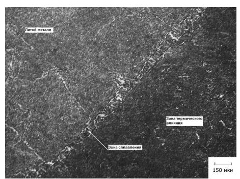
Рисунок 5 — Микроструктура зоны сплавления сварного соединения стали 24X2HAч со структурой бейнита зернистой морфологии
