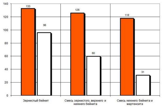
Рисунок 4 — Влияние структуры ЗТВ сварного соединения стали 24X2НАч на ударную вязкость по линии сплавления КСU, Дж/см<sup>2</sup> при комнатной температуре (левые столбцы) и температуре испытаний -60°C (правые столбцы)
