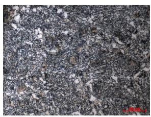
Рисунок 2 — Микроструктура мезоферрита и зернистого бейнита в ЗТВ сварного соединения стали 24X2HAч
