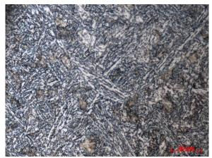
Рисунок 3 – Микроструктура мартенсита в ЗТВ сварного соединения стали 24X2HAч
