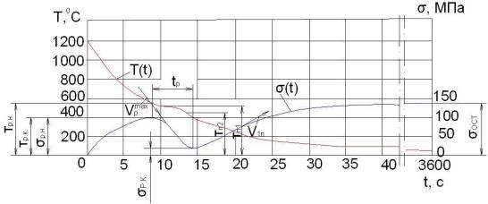
Рисунок 1 — Характерные кривые изменения температуры T(t) и кинетики развития напряжений  $\sigma(t)$  в жесткозакрепленном образце при охлаждении по TДЦС
