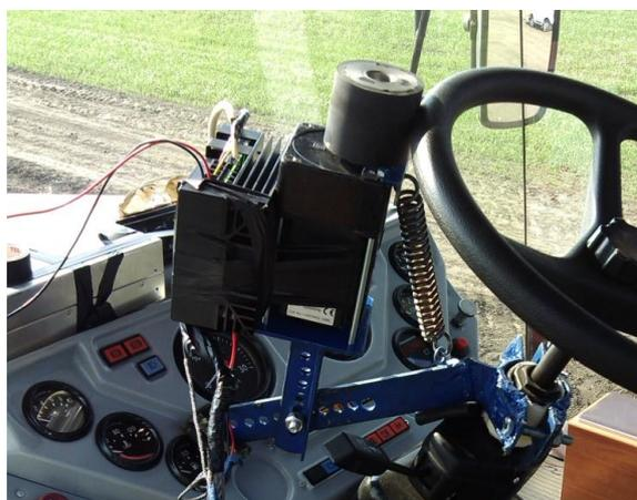
Рисунок 1 - Внешний вид подруливающего устройства
