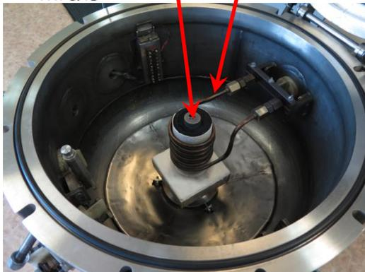
Рисунок 1 – Рабочая камера станда высокотемпературных материаловедческих испытаний ВЧГ-135
