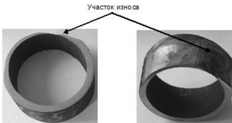
Рисунок 1 – Элемент трубы с покрытием
