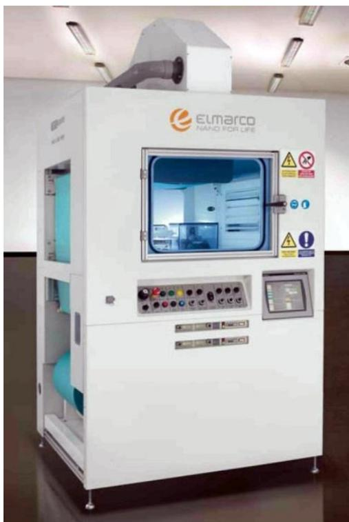
Рисунок 2 – Установка Nanospider™ NS 1WS500U
