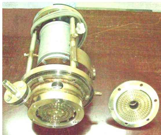
Рисунок 2 – Внутреннее устройство многоступенчатого РПА (статорная крышка снята)
