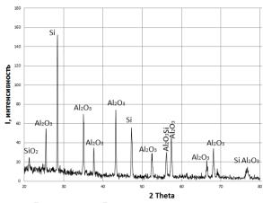
Рисунок 4 – Рентгенограмма смеси 60 % SiO<sub>2</sub> + 40 % AI после термообработки в течение 20 минут в предварительно нагретой до 1000 °C печи
