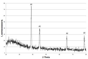
Рисунок 3 – Рентгенограмма смеси 60 % SiO<sub>2</sub> + 40 % Al механоактивация в течение 7 минут
