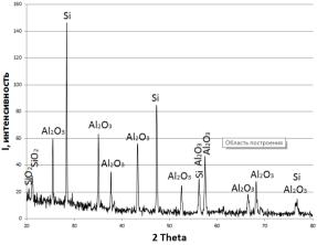
Рисунок 4 — Рентгенограмма смеси  $60 \% SiO_2 + 40 \% Al$  после постепенного нагрева до  $1000 \degree C$  и выдержки в течение 20 минут
