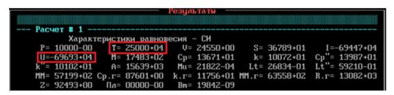
Рисунок 1 — Моделирование результатов характеристики равновесия для реакции  $60 \% SiO_2 + 40 \% Al$
