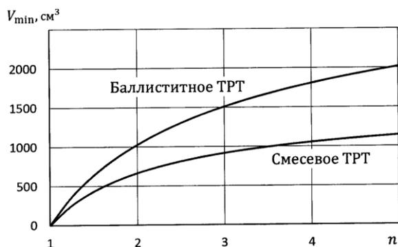
Рисунок 3 – Зависимость значения минимального свободного объема камеры сгорания  $V_{min}$  от параметра  $n$
