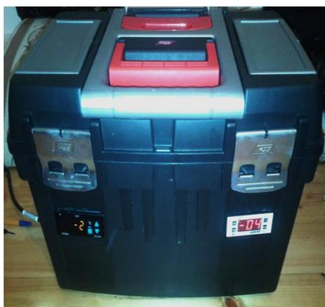
Рисунок 2 – Внешний вид опытного образца ТЭС для хранения и перевозки биологического материала
