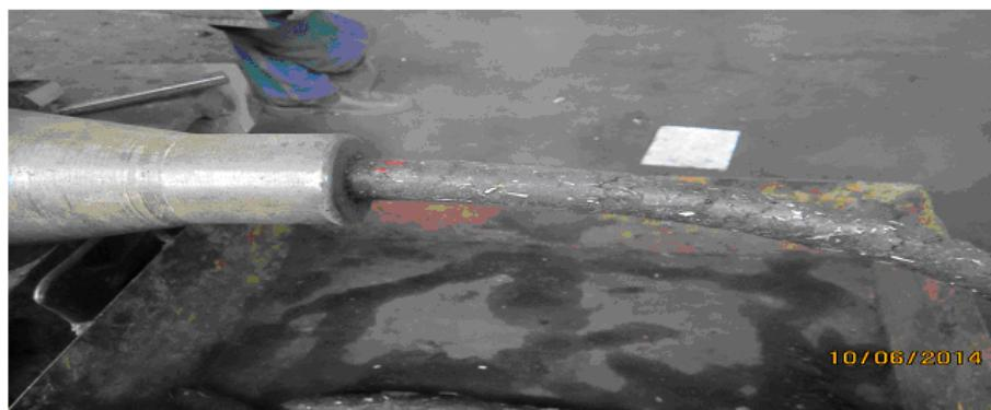
Рисунок 4 - Неразрезанный брикет, получаемый из ТБО
