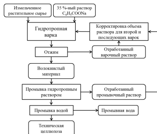
Рисунок 1 – Схема многократной варки мискантуса в растворе C_6H_5COONa
