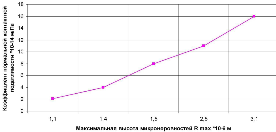
Рисунок 4 – Изменение коэффициента нормальной контактной податливости при различных параметрах микрогеометрии
