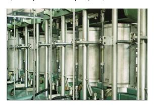
Рисунок 2 – Испытание образцов СПА на испытательных машинах ZSt-2/3
