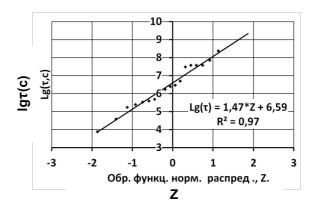
Рисунок 3 — Нормированные диаграммы распределения временной прочности (а) и логарифма долговечности (б) образцов в испытанной выборке
