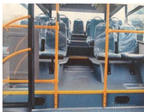
Рисунок 4 – Перепады уровня пола в автобусе
