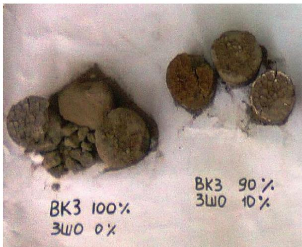
Рисунок 1 – Образцы силикатного кирпича с содержанием ВКЗ 100, 90%
