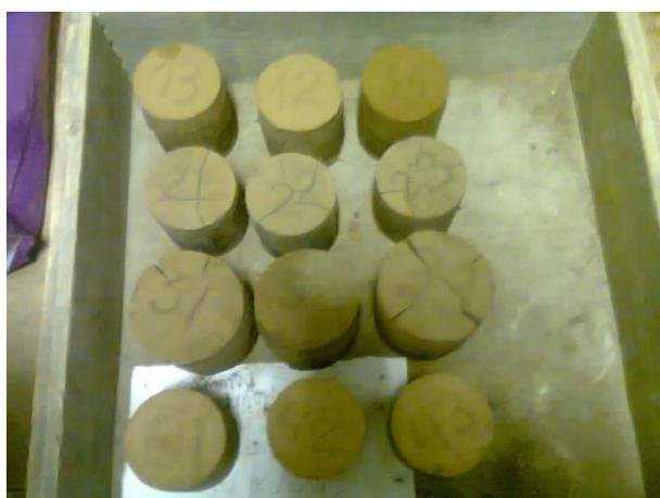
Рисунок 3 – Образцы силикатного кирпича на основе ВКЗ и ЗШО с добавкой извести
