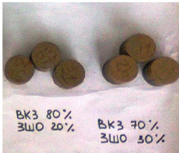
Рисунок 2 – Образцы силикатного кирпича с содержанием ВКЗ 80, 70%
