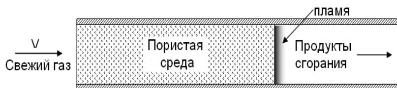
Рисунок 1 – Схема модулируемой системы
