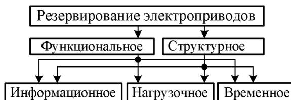
Рисунок 1 – Связь видов резервирования в обеспечении отказоустойчивости электроприводов
