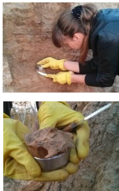
Рисунок 1 – Отбор образцов грунта ненарушенной структуры.
