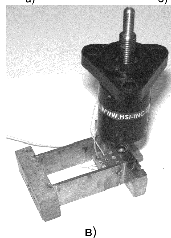
Рисунок 1 - Конструкция пьезопривода (вид сверху) с различными вариантами пьезоактивной части: а – изгибные колебания; б – продольные колебания; в – внешний вид
