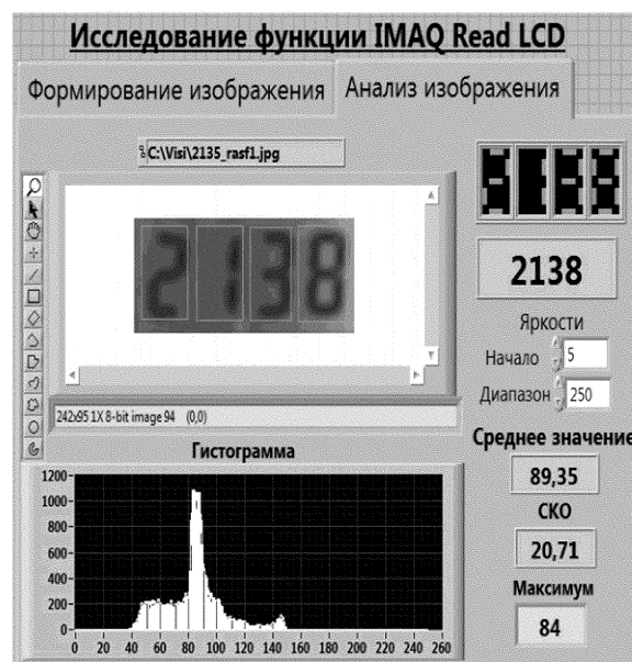
Рисунок 3 – Лицевая панель программы для исследования функции считывания показаний цифрового индикатора:
