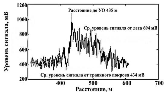
Рис.4. Калибровка сигнала с использованием уголкового отражателя
