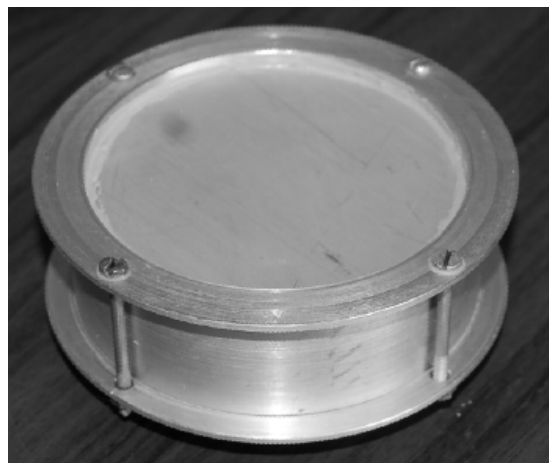
Рисунок 1 - Внешний вид системы для охлаждения элементов РЭА с повторно-кратковременными тепловыделениями
