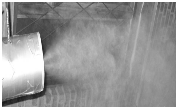
Рисунок 3 – Фотография образующегося тумана из мелких частиц льда
