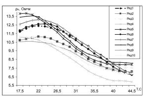
Рисунок 1 – Зависимости удельного объемного сопротивления партии образцов МКЭ-1 от температуры
