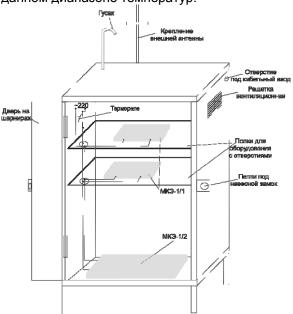
Рисунок 3 - Контейнер для оборудования электронной связи с системой обогрева
