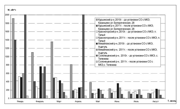
Рисунок 4 - Диаграмма потребления электрической энергии оборудованием электронной связи до и после установки систем обогрева с МКЭ
