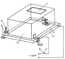
Рисунок 2 - Система обогрева трехфазного индукционного счетчика в щите раздельного учета электроэнергии
