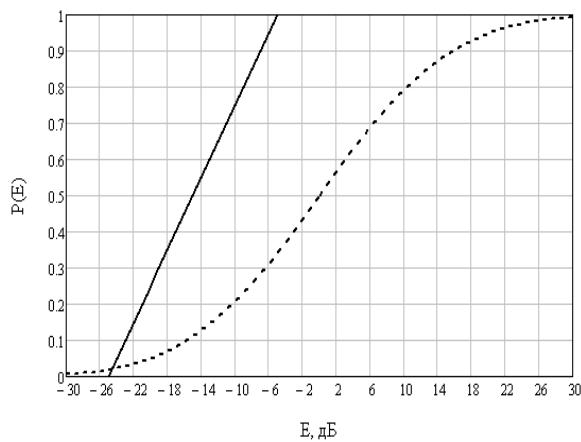
Рисунок 6 - Линейная (сплошной график) и исходная (пунктирный график) зависимости коэффициента восприятия от уровня ощущений формант.
