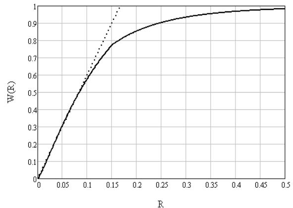
*Рисунок 5 - Зависимость словесной разборчивости от формантной (сплошной график — по методике, пунктирный — предлагаемый линейный вариант)*
