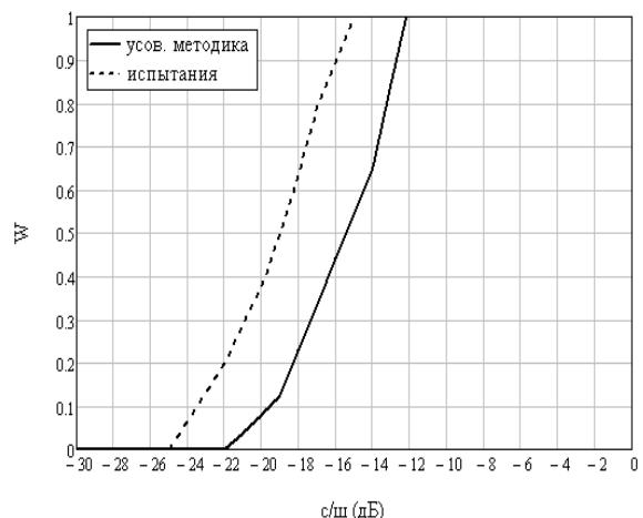
Рисунок 7 - Зависимости  $W(c/w)$  для белого шума, полученные по усовершенствованной методике и по результатам испытаний
