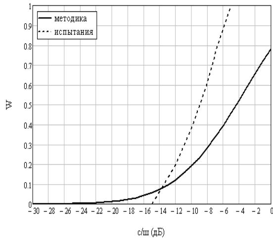
*Рисунок 4 - Зависимости  $W(c/w)$  для формантоподобного шума, полученные по методике и по результатам испытаний*
