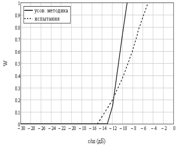
Рисунок 9 - Зависимости  $W(c/w)$  для формантоподобного шума, полученные по усовершенствованной методике и по результатам испытаний
