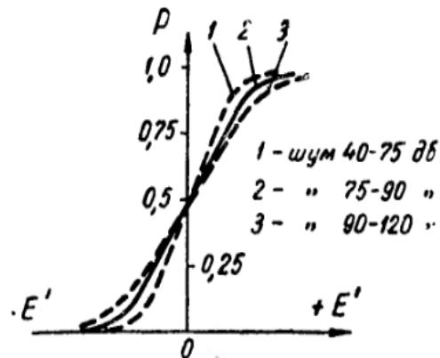
Рисунок 1 - Характер изменения крутизны функции  $P(E)$  при различной интенсивности шума[2]
