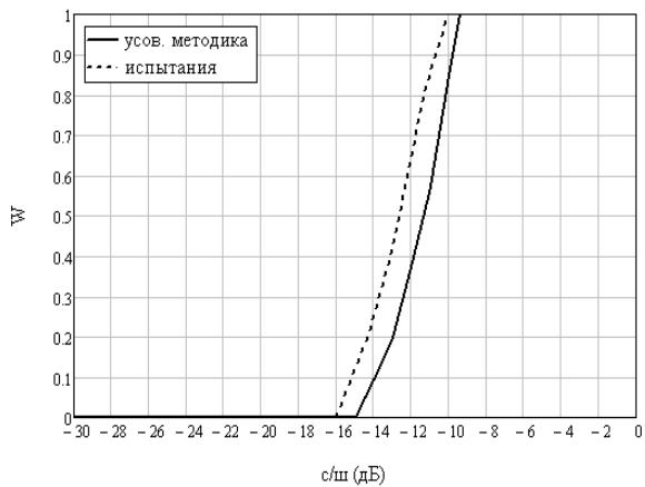
Рисунок 8 - Зависимости  $W(c/w)$  для розового шума, полученные по усовершенствованной методике и по результатам испытаний
