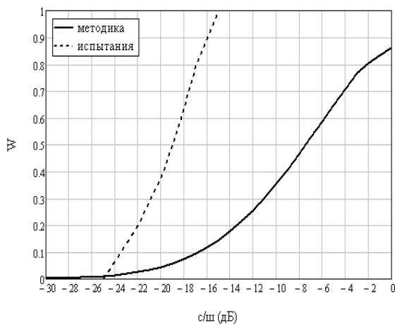
*Рисунок 2 - Зависимости  $W(c/w)$  для белого шума, полученные по методике и по результатам испытаний*
