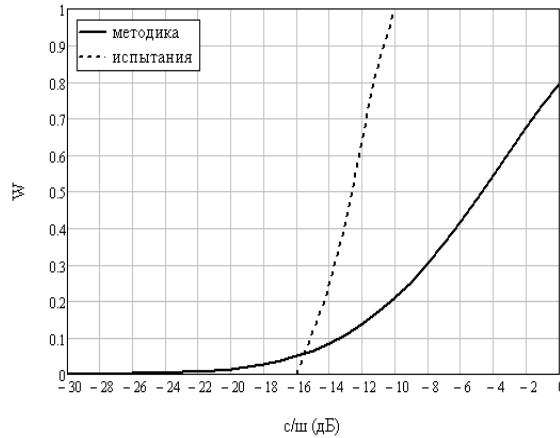
*Рисунок 3 - Зависимости  $W(c/w)$  для розового шума, полученные по методике и по результатам испытаний*
