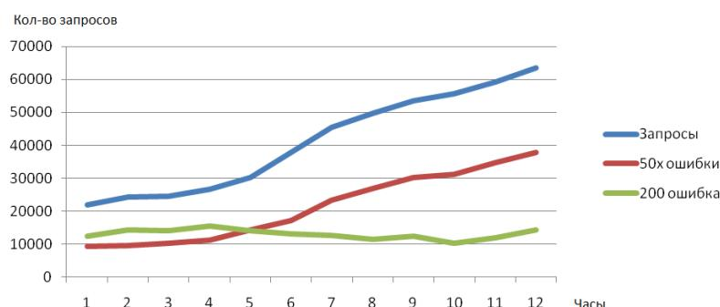
Рисунок 2 - График роста количества запросов за 12 часов работы сервера (классическая DDoS атака)
