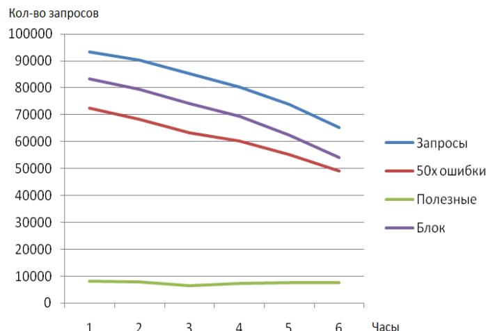
Рисунок 3 - Применение механизма фильтрации на базе нейронной сети за час работы после внедрения
