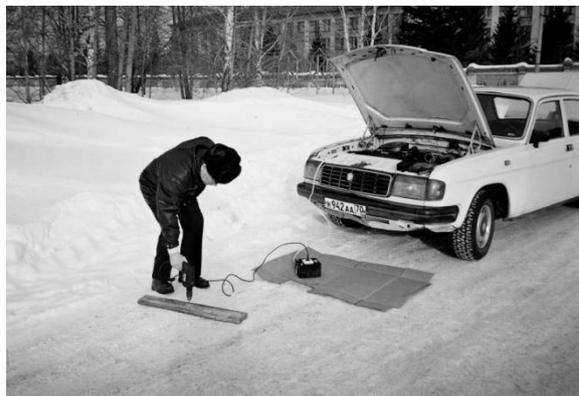
Рисунок 7 - Автомобильная электростанция, нагруженная на дрель
