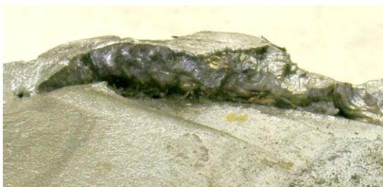
Рисунок 4 – Участок излома с темными включениями
