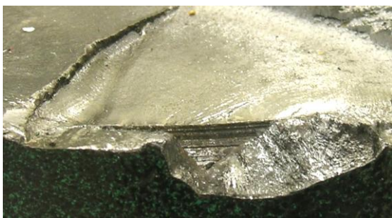
Рисунок 3 – Участок излома с кольцевыми канавками
