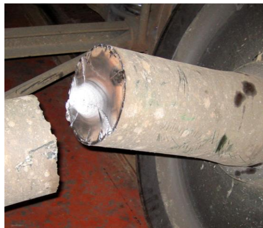
Рисунок 1 – Вид разрушенной оси
