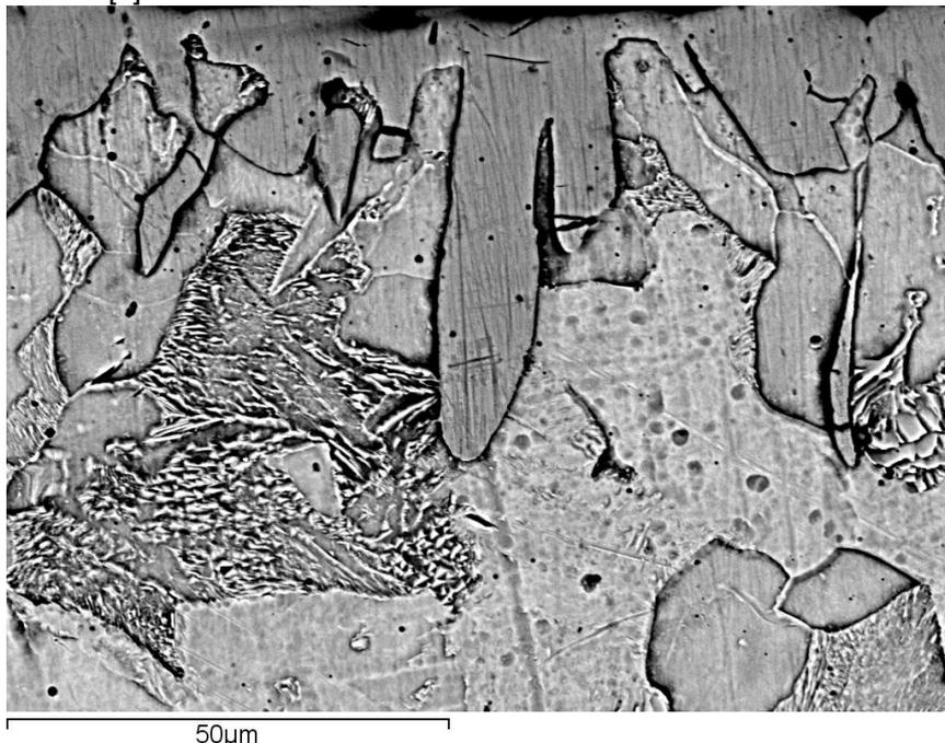
Рисунок 2 - Поперечный микрошлиф боротитанированного слоя на стали
