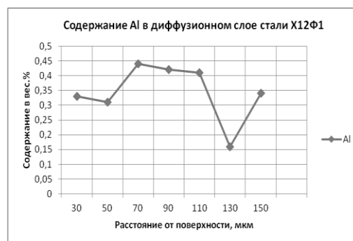
Рисунок 14 - Содержание ванадия и алюминия в диффузионном слое стали Х12Ф1, в вес. %
