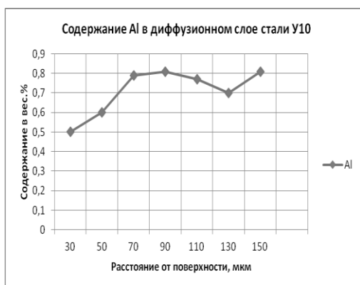
Рисунок 12- Содержание ванадия и алюминия в диффузионном слое стали У10, в вес. %
