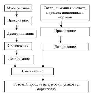
Рисунок 4 — Технологическая схема производства пищевого концентрата напитка
