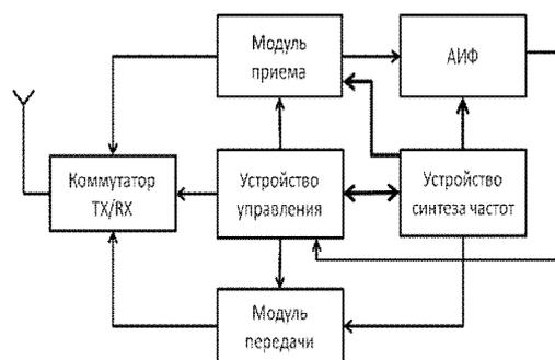
Рисунок 1 – Блок-схема приемопередающего блока
