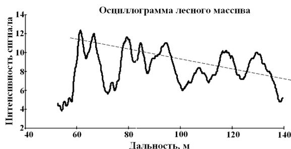
Рисунок 7 – Осциллограмма отраженного сигнала от хвойного леса
