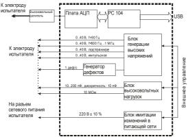
Рисунок 2 - Структурная схема установки для аттестации электроискровых дефектоскопов
