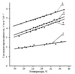
Рисунок 3 – Температурная зависимость удельной проводимости проб воды на ТЭЦ – 3 (буквами обозначены места установки датчиков, соответствующие обозначениям рисунка 1)
