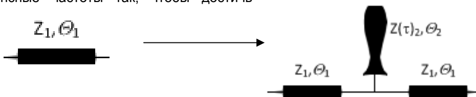
Рисунок 2 – Схема замещения последовательной линии передачи T-образной плавно-нерегулярной разомкнутой на конце
