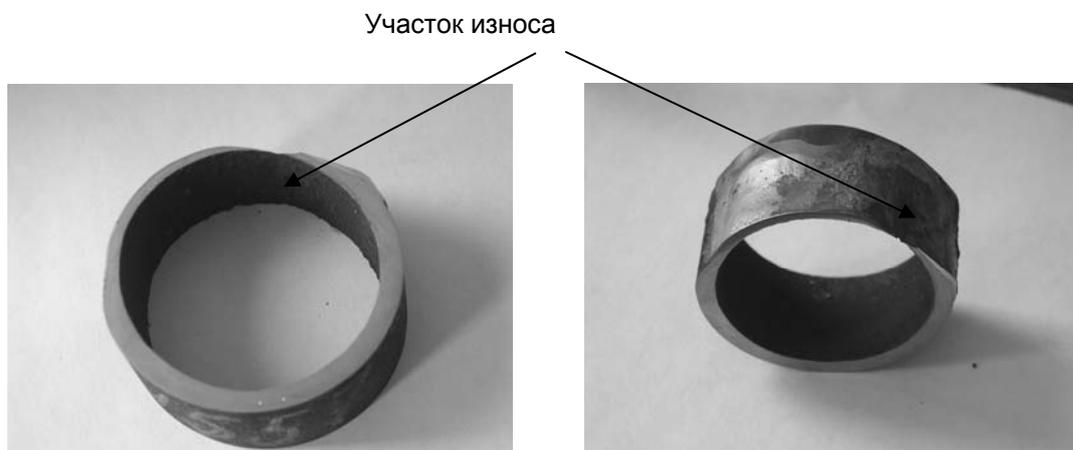
Рисунок 1 - Элемент трубы с покрытием
