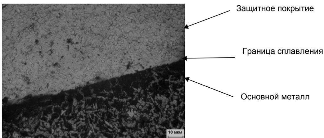
Рисунок 3 - Распределение карбидной составляющей и граница сплавления защитного покрытия и основного металла
