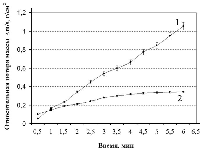
Рисунок 10 - Результаты испытаний покрытий на износостойкость о жестко закрепленные абразивные частицы:
