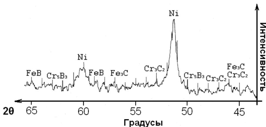
Рисунок 6 - Фазовый состав защитных покрытий
