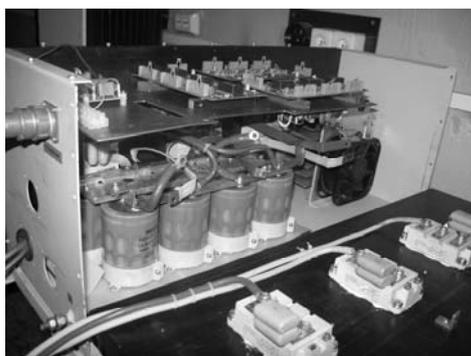
Рисунок 2 – Размещение силовых элементов в генераторе
