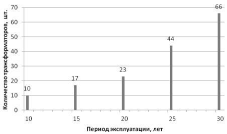
Рисунок 1 – Распределение трансформаторов по годам эксплуатации
