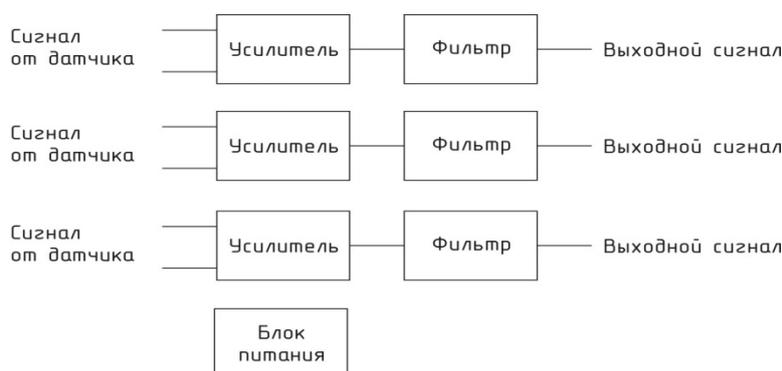
Рисунок 4 - Блок схема устройства для измерения в одной точке
