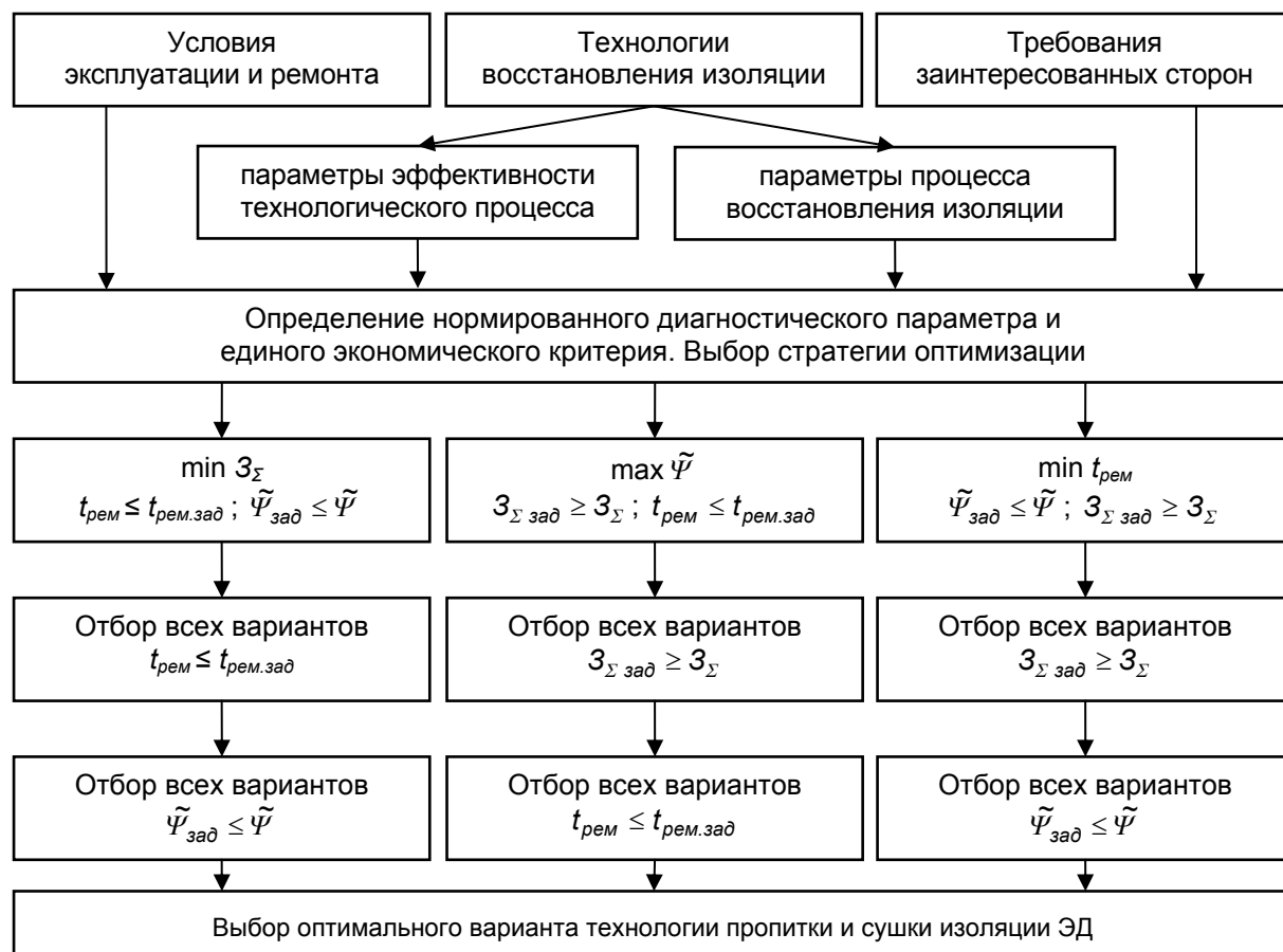
Рисунок 4 – Блок-схема выбора оптимальной технологии пропитки и сушки изоляции в зависимости от условий эксплуатации ЭД
