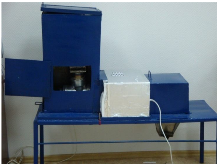
Рисунок 4 – Установка для термической обработки сыпучих диэлектрических материалов, согласно патенту РФ на изобретение №2311002
