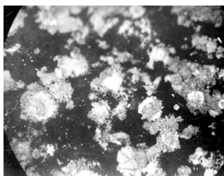
Рисунок 2. Область поверхностной кристаллизации расплава при 1266 °С
