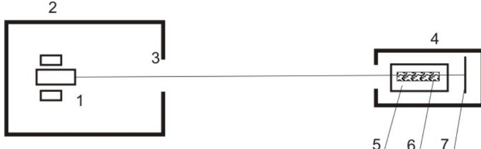
1 – лазерный регистратор с блоками питания и аппаратурой обработки и управления; 2 – рабочая лаборатория; 3 – окно лаборатории; 4 – палатка; 5 – стол; 6 – кювета 10×100 см; 7 – рассеиватель
