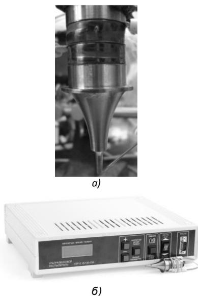
Рисунок 4. Разработанное оборудование: а – ультразвуковая колебательная система для распыления; б – ультразвуковой распылитель в сборе
