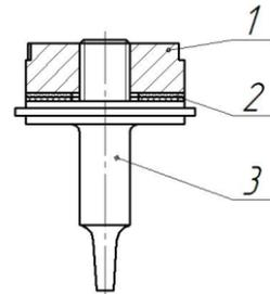
Рисунок 2. Конструкция ультразвуковой колебательной системы для распыления: 1 – пьезоэлектрические элементы; 2 – частотопонижающая накладка; 3 – концентратор механических колебаний
