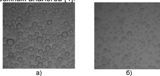
Рисунок 6. Фото каплей распыляемых жидкостей уловленных иммерсионной средой: а – вода; б – этиленгликоль
