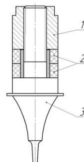
Рисунок 3. Конструкция разработанной ультразвуковой колебательной системы для распыления жидкостей: 1 – пьезоэлектрические элементы; 2 – частотопонижающая накладка; 3 – концентратор механических колебаний
