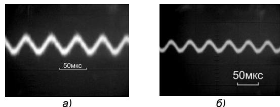
Рисунок 4 – изображение сигнала на экране осциллографа при мощности излучателя 31,28 Вт. а)- без фильтра, б) – с фильтром
