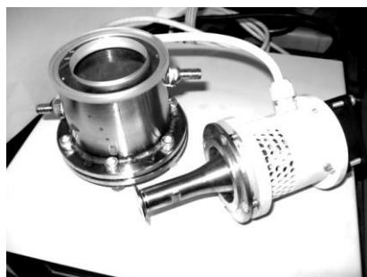
Рисунок 3 – Кавитационный широкополосный акустический излучатель (УЗ вибратор отсоединен)
