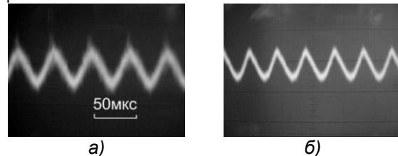
Рисунок 5 – изображение сигнала на экране осциллографа при достижении мощности излучателя 60 Вт. а)- без фильтра, б) – с фильтром
