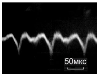
Рисунок 6 – изображение отфильтрованного сигнала на экране осциллографа при мощности излучателя 60 Вт после окончания формирования кавитационного кластера
