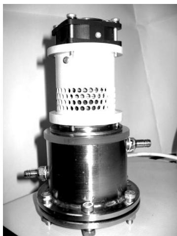
Рисунок 2 – Кавитационный широкополосный акустический излучатель
