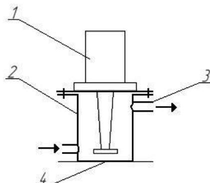
Рисунок 1. Конструктивная схема кавитационного акустического широкополосного излучателя (КАШИ)
