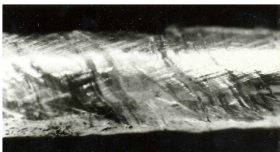
Рисунок 2. Микрофотография поверхности волокна TICI, испытанного на растяжение после предварительного изгиба
