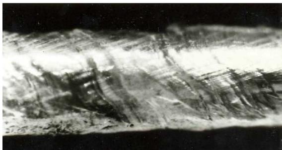
Рисунок 2. Микрофотография поверхности волокна TICI, испытанного на растяжение после предварительного изгиба
