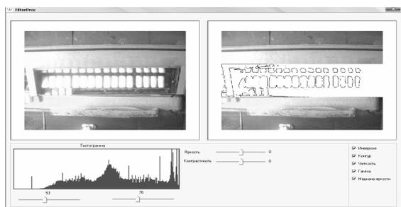
Рисунок 4 Форма для исследования работы алгоритмов выделения контуров объектов, представляемых для идентификации нейронной сети.
