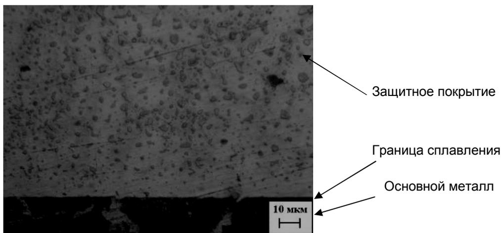
Рисунок 9 - Распределение карбидной составляющей и граница сплавления защитного покрытия и основного металла
