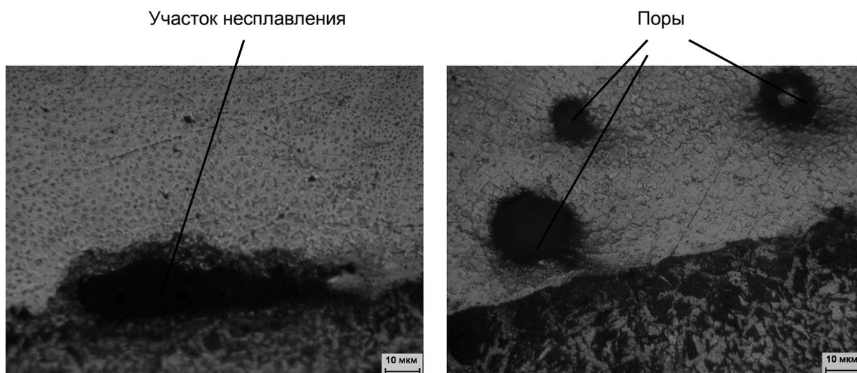
Рисунок 4 - Наличие в покрытии дефектов металлургического характера
