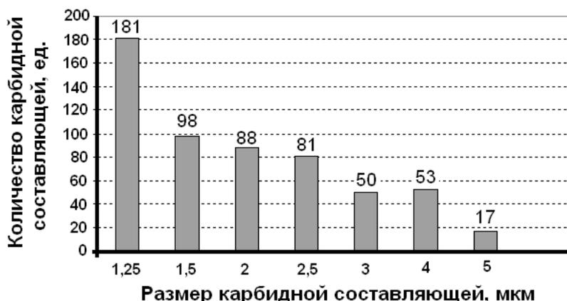
Рисунок 5 - Гистограммы упрочняющей фазы в защитном покрытии
