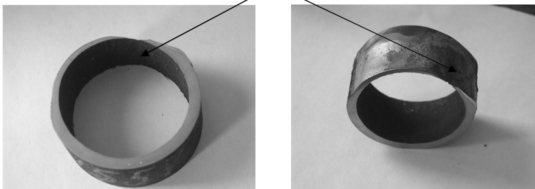
Рисунок 1 - Элемент трубы с покрытием
