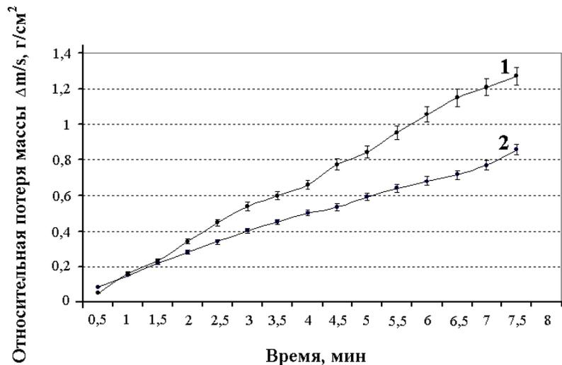
Рисунок 8- Результаты испытаний покрытий на износостойкость о жестко закрепленные абразивные частицы: 1 – сталь 45; 2 – образец покрытия, полученного газопорошковой наплавкой
