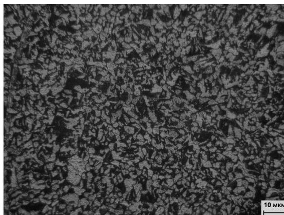
Рисунок 2 - Микроструктура основного металла
