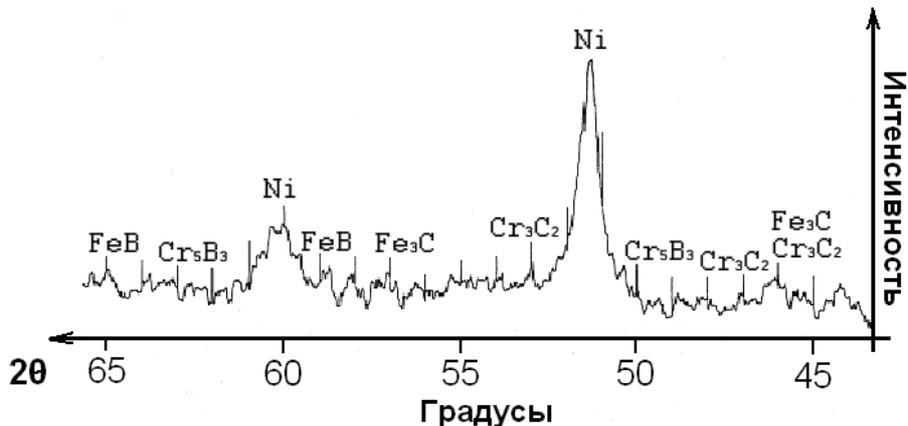
Рисунок 6 - Фазовый состав защитных покрытий
