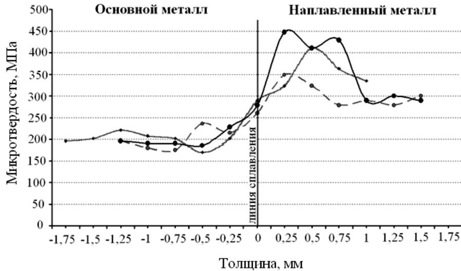
Рисунок 7 - Распределение микротвердости
