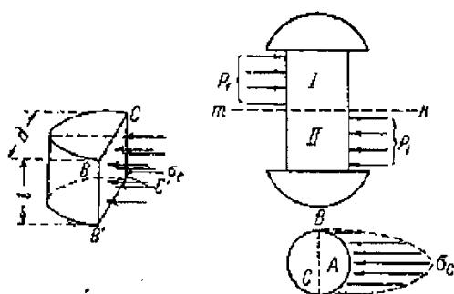
**Рисунок 2 –Передача давлений на стержень заклепки**
