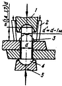
**Рисунок 1- Заклепочное соединение**
